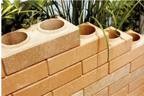
Figura 24: Tijolo feito com resíduos de construção civil
